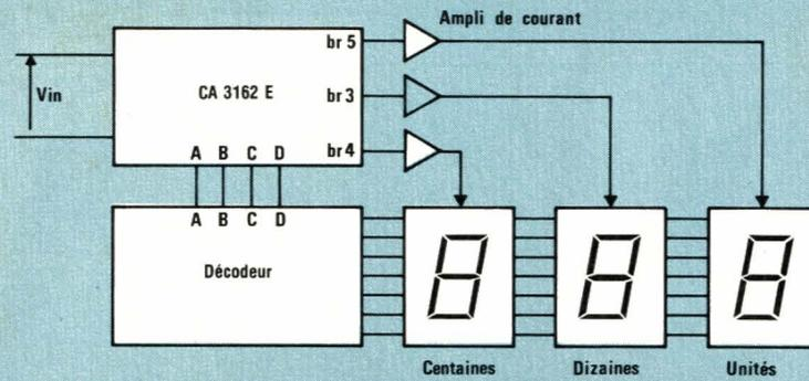
Figure 1a : Schéma synoptique d'utilisation du CA 3162 E
