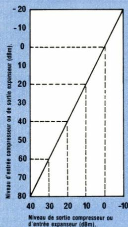
Figure 3 - Courbe de l'expandeur NE 570
