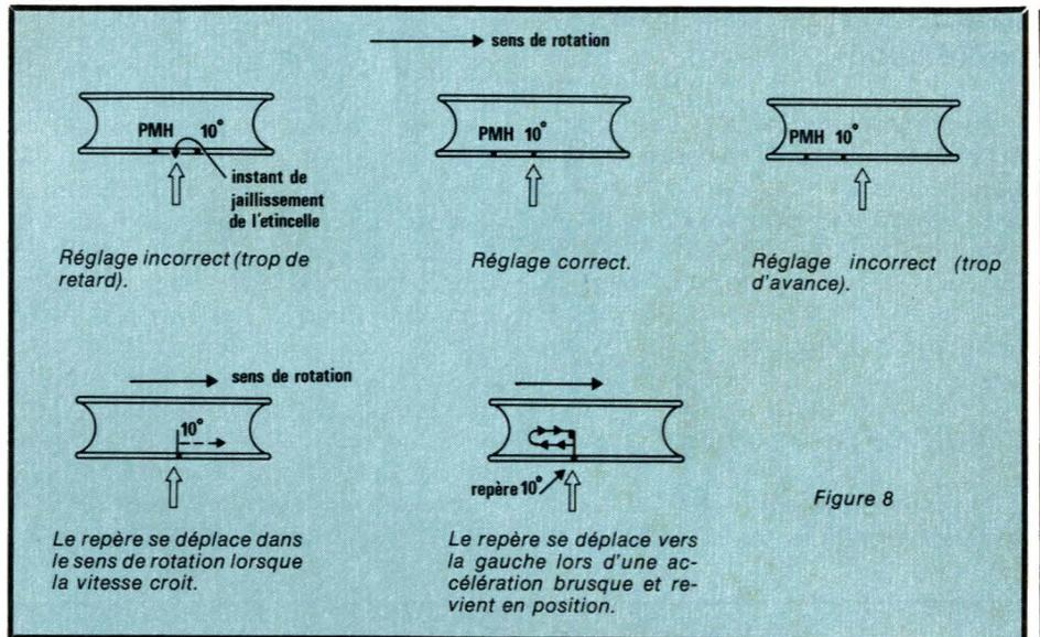
La mesure de l'avance se fait en comparant la position d'un repère (fixe) sur le moteur, d'un repère (mobile), généralement tracé sur un organe tournant (volant, poulie etc...).
