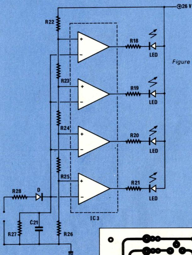
Figure 7 - Circuit vu-mètre.
