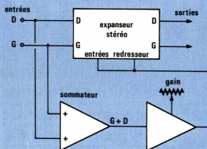
Figure 2 - Schéma synoptique de l'expandeur.
