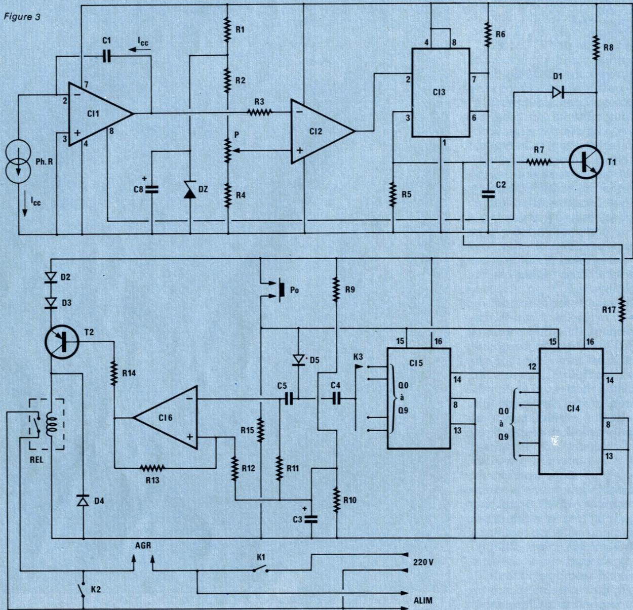
seuse, et la photopile Ph.P délivre son courant de court-circuit  $I_{cc}$ , proportionnel à l'éclairement. Les courants d'entrée de l'amplificateur CA 3140 restent toujours très faibles (10 pA de valeur typique), cette même intensité  $I_{cc}$  charge le condensateur d'intégration C1.
