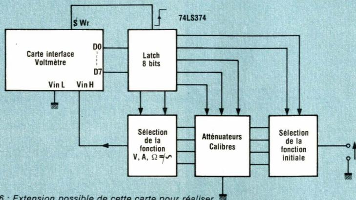
Figure 6 : Extension possible de cette carte pour réaliser un système de mesure automatique
