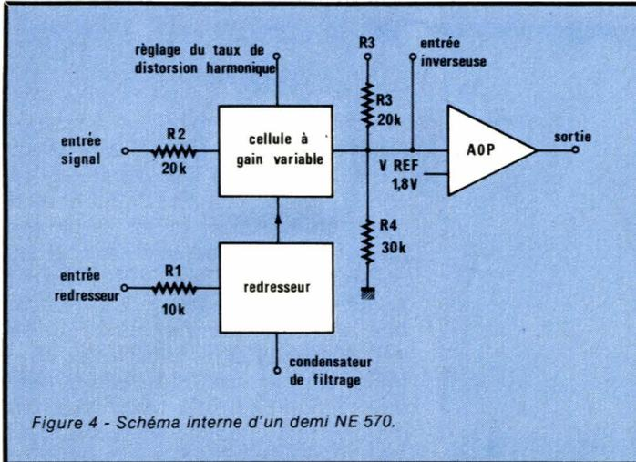
Figure 4 - Schéma interne d'un demi NE 570.
