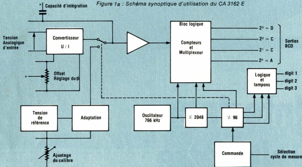
Figure 1b : Schéma fonctionnel du CA 3162 E
