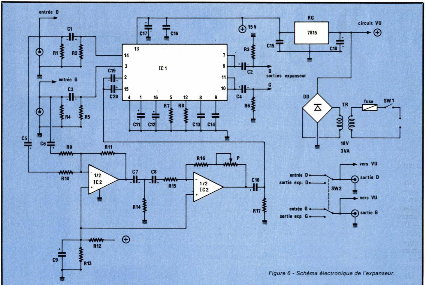
Figure 6 - Schéma électronique de l'expanseur.
