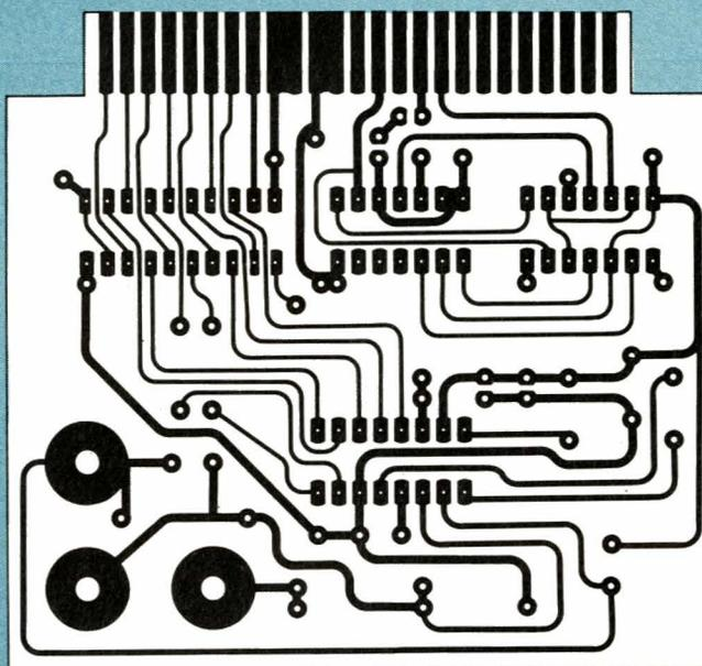
Figure 4 : Plan du circuit imprimé, à reproduire fidèlement.
