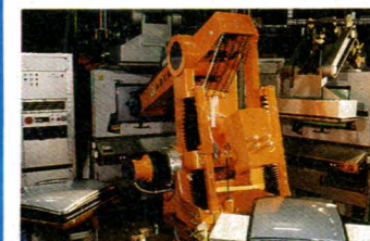
Positionnement du tube dans le réceptacle d'aimantation de l'anneau multipôle.
