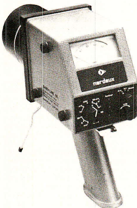
A - Le dosimètre - débitmètre BABYLINE 81, construit autour d'une chambre d'ionisation remplie d'air à la pression atmosphérique, comporte une paroi simulant, par son absorption, le comportement de l'épiderme. Il permet ainsi de mesurer le débit de dose (et, par intégration, la dose) que recevrait les tissus humains, pour des rayonnements X, \beta et \gamma .
