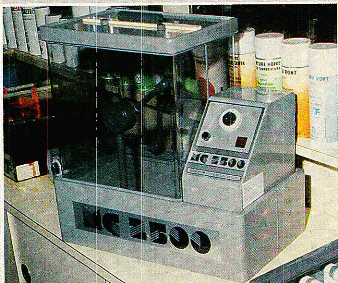
— Machine à graver à jets rotatifs (MG 2 500). Dans ce genre de machine le perchlorure de fer utilisé est « suractivé » et chauffé.
