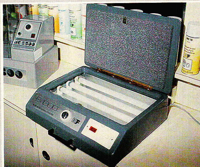
— Banc à insoler aux U.V. en principe conçu pour le simple face mais qui avec un peu d'astuce fait des merveilles en double face.
