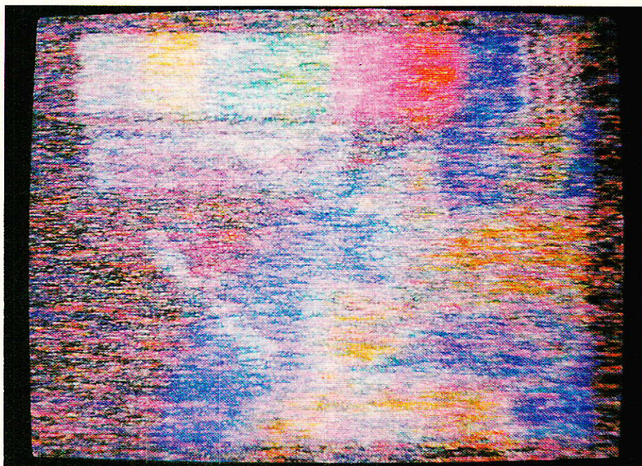
Mire obtenue ! Via une parabole de 1,80 m de Ø. F = 1,6 dB à Ghardaïa située à - 20 dB environ de PV (théorique).
