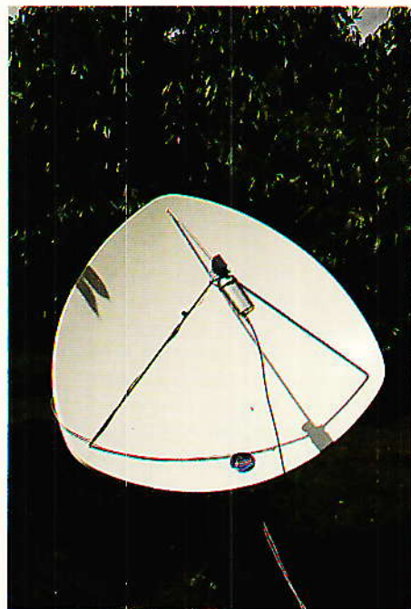
Parabole Stratispace à monture polaire dans le jardin de l'auteur.
