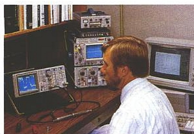
Tektronix : l'analyseur de spectre portable 2710 avec son extenseur de gammes et son interface GPIB.
