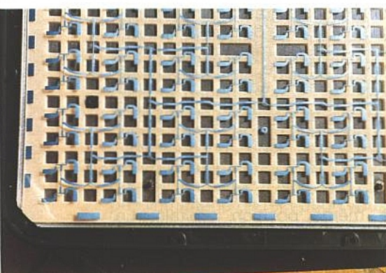
Figure 6 : Le conducteur intermédiaire avec les antennes et le réseau de couplage.
