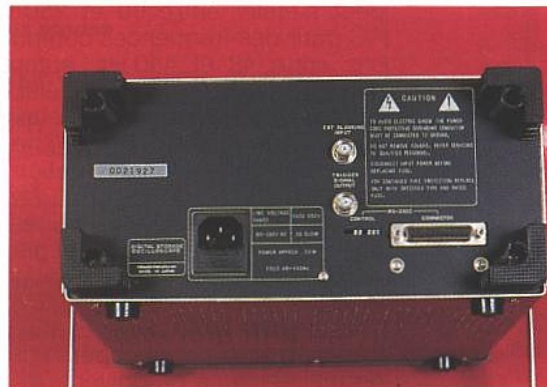
La face arrière avec le connecteur DB 25 RS 232 C, le jeu de switches de configuration. On notera aussi les prises d'entrée axe Z et de sortie trigger (BNC).
