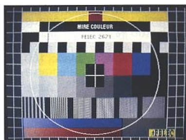
La mire composite permet d'un coup d'œil, d'apprécier l'état de fonctionnement d'un téléviseur.
