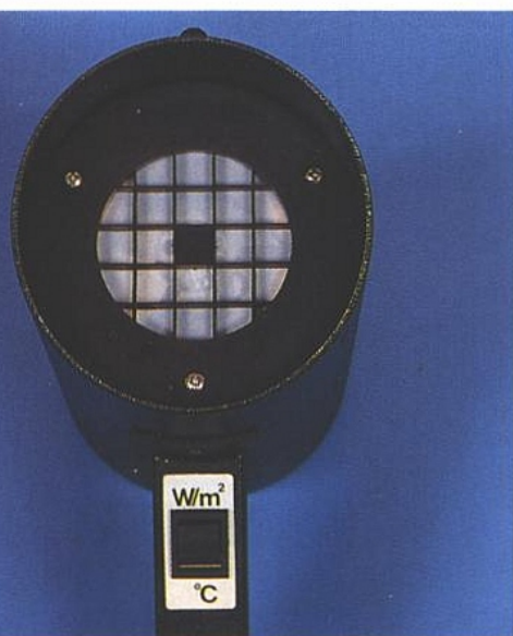
Le capteur avec le filtrage. On remarquera le commutateur trois positions devant la poignée.
