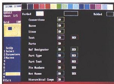
Menu d'impression sous Pads-Logic. Choix des textes devant apparaître sur le dessin, et sélection de leur présentation (encadrés ou non).
