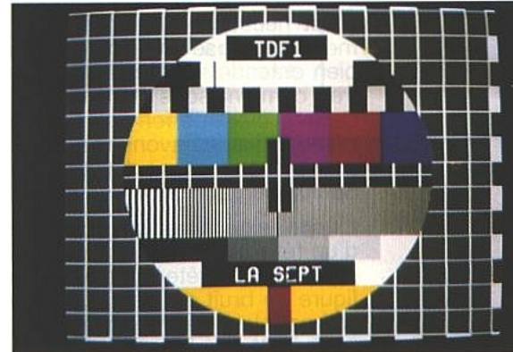
D2 MAC : Qualité d'image correspondant à un rapport porteuse/bruit de 9 dB.
