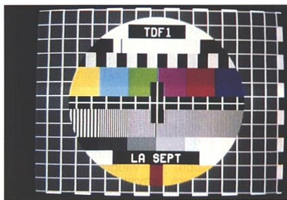
D2 MAC : Qualité d'image correspondant à un rapport porteuse/bruit de 17 dB.
