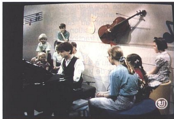
SECAM : Qualité d'image via TELECOM 1C. Le rapport signal/bruit vaut 48 dB.
