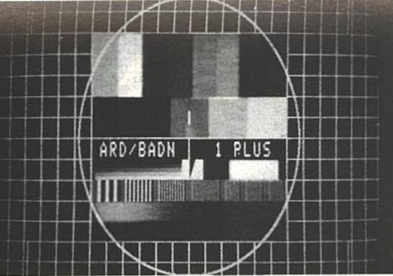
Aspect d'image obtenu au moyen de l'ensemble source/tête (F : 1,3 dB) orienté, dans une zone à 63 dBW. Transmission test en 16/9.
