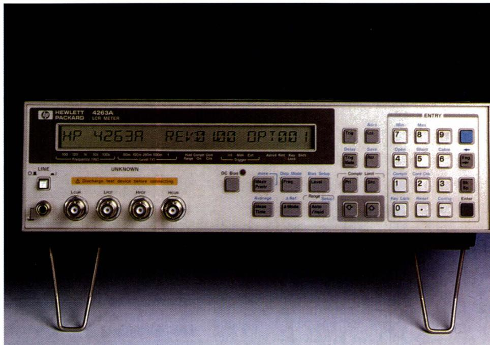
Nous préférons qualifier le HP 4263A de mesureur R, L, C plutôt que de pont d'impédances dès lors que le processus de mesure s'apparente à une méthode volt-ampèremétrique comme en témoigne la **figure 1** et non à un pont de mesure.
