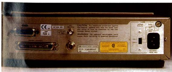
La face arrière avec les connecteurs IEEE et manipulateur externe ainsi que les prises BNC pour les entrées trigger et bias.
