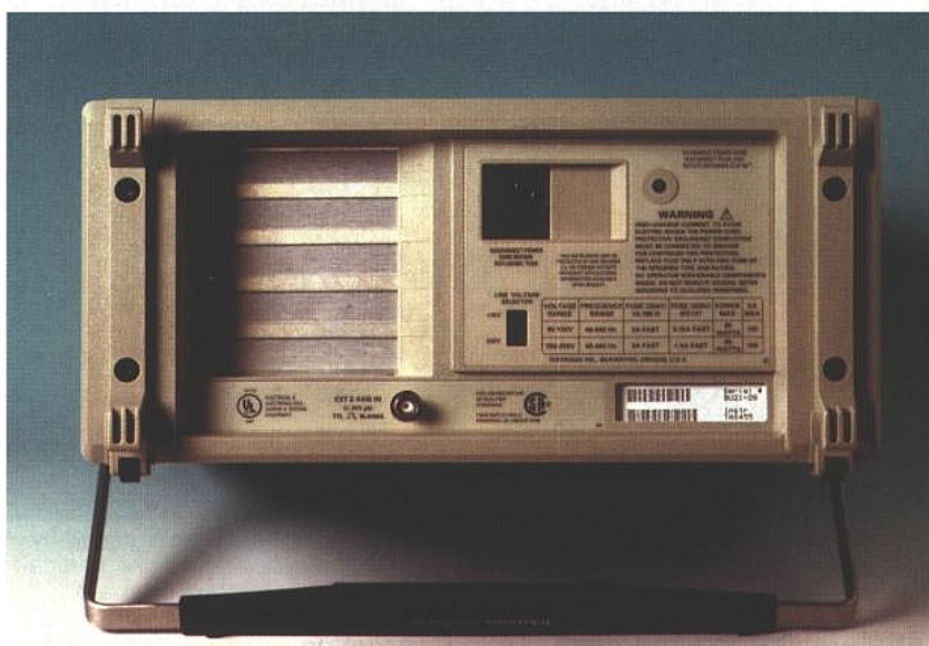
La face arrière avec l'entrée secteur commutable, l'entrée axe Z de modulation d'intensité des traces et cinq ouvertures présageant de possibles extensions futures.
