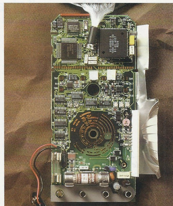
Le 2030 à nu, le carénage interne en plastique transparent thermoformé a été ôté. On distingue l'ensemble de l'électronique où la technologie CMS se taille la plus grosse part.
