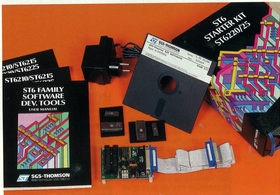
Le contenu du kit de développement ST 62XX
