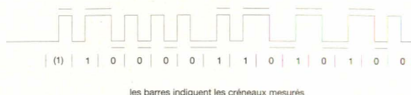
■ Figure 3 : représentation physique d'une trame quelconque avec interprétation des bits consécutifs. Les barres indiquent les créneaux mesurés.
