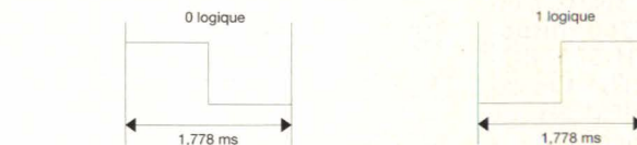
■ Figure 1 : définition des "0" et "1" logiques en RC5.
