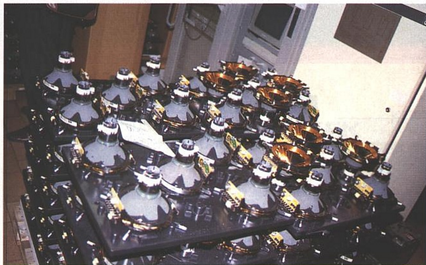
■ Déflecteurs en attente de recevoir leur tube cathodique.
