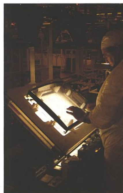
■ Contrôle de l'homogénéité des couches de luminophores.
