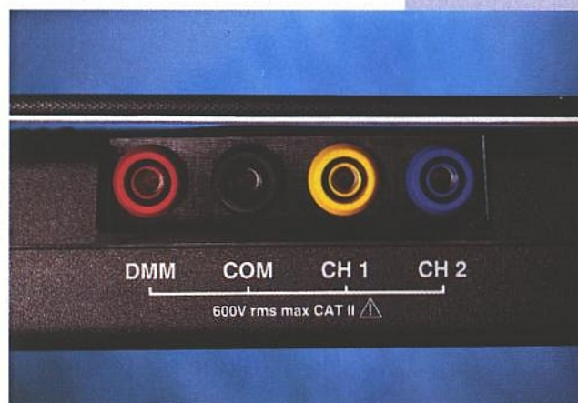
Le Tekmeter est doté de cordons multimètre haute sécurité. Cela n'affecte pas les performances dynamiques mais s'avère plus pratique surtout avec la différenciation par couleur.
