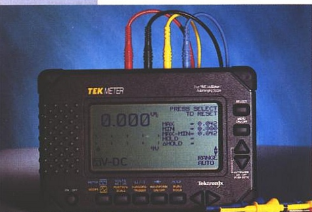
L'écran en mode multimètre : tout est affiché y compris les extrêmes.
