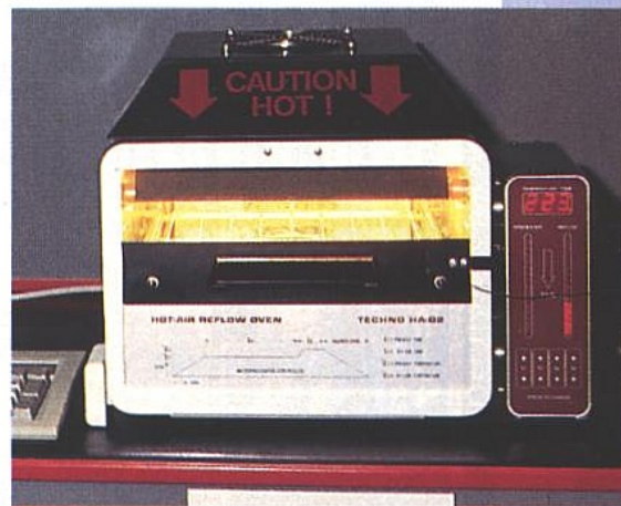
Le four en cycle de refusion. Les trois tubes à quartz 250W sont en action.
