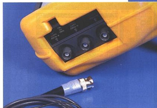
Les entrées BNC de voies et de déclenchement externe affectées au scope et au fréquencemètre.
