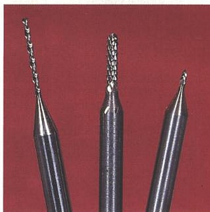
Jeu d'outils utilisés. Tous présentent un fût de 3 mm s'adaptant dans la douille (3 mm) LPKF et sont réaffutables.
