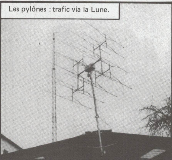
Au second plan, une antenne sophistiquée pour recevoir Météosat. Au premier plan, un «bricolage» TONNA pour la même réception ! Une différence : les caractéristiques sont supérieures avec l'antenne à éléments et le maniement en est plus simple.
