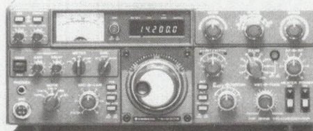
Transceiver TS 830 Émission réception. Bandes amateurs USB/LSB/ CW - 110 W HF 230 W PEP. Alimentation secteur incorporée.
