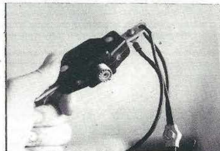
Arrivée du câble coaxiale sur SO239
