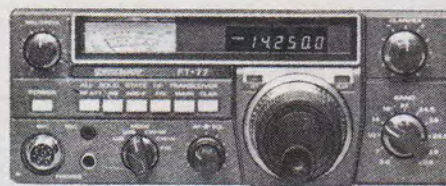
FT-77 Émetteur/Récepteur toutes bandes décimétriques BLI/BLC - CW et FM. 200 W PEP.
