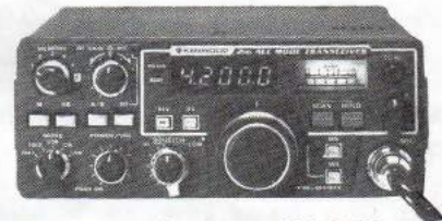
Emetteur-récepteur TR 9130 144 à 146 MHz. Tous modes. Puissance 25 W - HF.
