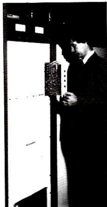
Nouvelle génération d'émetteurs TV récemment annoncée par Marconi. La série B7500 comprend des puissances de 1 kW à 25 kW pour la Bande III (174-225 MHz).
