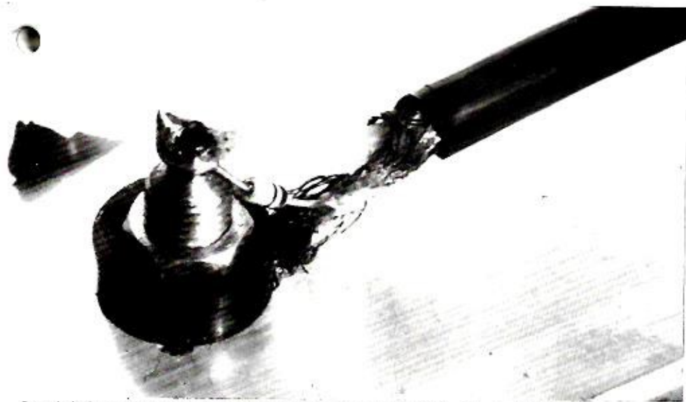
Détail de la soudure du coaxial sur l'une des fiches BANANES et de la DIODE.
