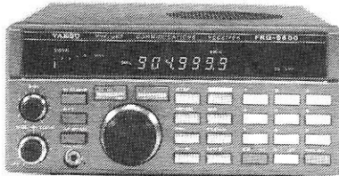
FRG 9600 Scanner 60-905 MHz 100 mémoires AM - FM - LSB - USB Alim 12 V pas de 5-10-12,5-25 kHz Prix 4 775,00 Frs
