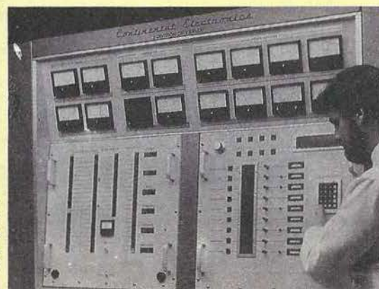
Emetteur ondes cours 500 kW AM de Continental Electronics. La chaîne d'amplification comporte un étage transistorisé à large bande nécessitant 1 V efficace en entrée, un étage driver constitué d'une triode 3CW20, et un ampli de puissance utilisant une tétrode 4CM400000.
