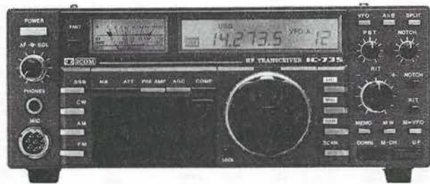
IC-735 F Décamétrique couverture générale en réception - Emission bandes OM 100 W tous modes.
