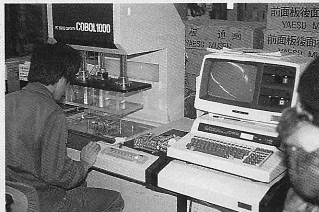
Test automatique des sous-ensembles.
