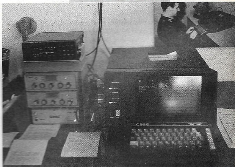
Radiotéléphone HF BLU 2 à 30 MHz 125 W Motorola MICOM XR.
