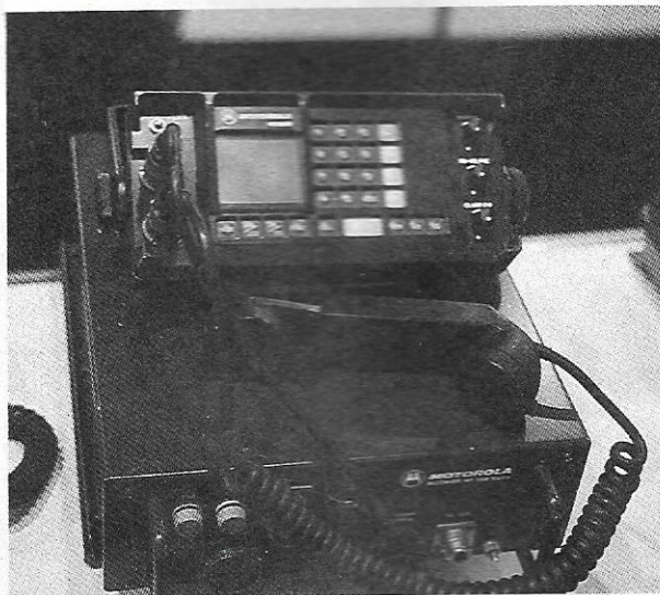
Radiotéléphone HF BLU 2 à 30 MHz 125 W Motorola MICOM XR.
