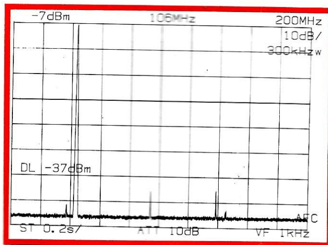
Spectre de sortie du transverter MR50 avec filtre
