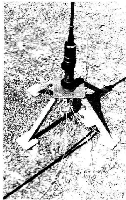
Présentation d'une antenne verticale de fabrication amateur, réalisée à partir de matériels de surplus. Elle permet l'émission à partir des 160 m. ★
