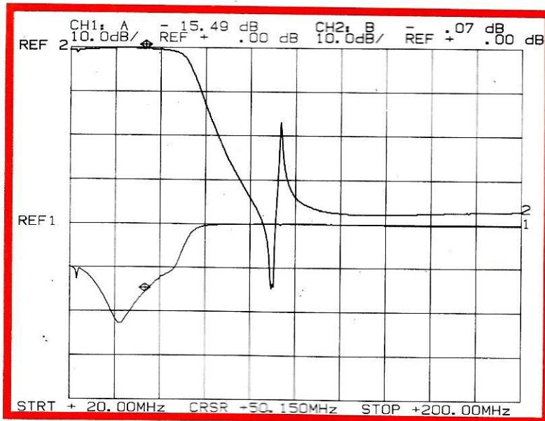
Courbe de transfert (S21) du filtre
