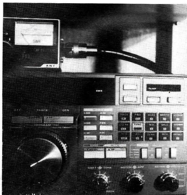
Photo n° 1 : La partie commande générale et le « PITCH »
