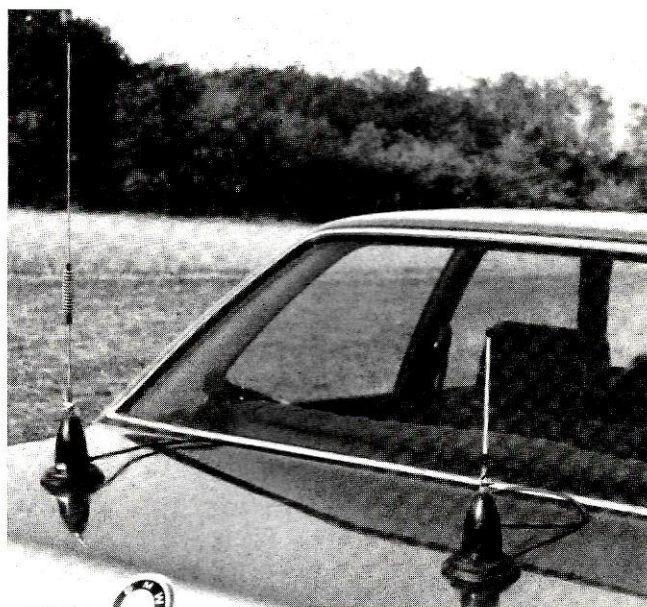
Antennes sur le coffre du mobile. A gauche, la colinéaire 432 pro, long. du brin 55 cm ; à droite, la SN 1/8, long. du brin 19 cm !
