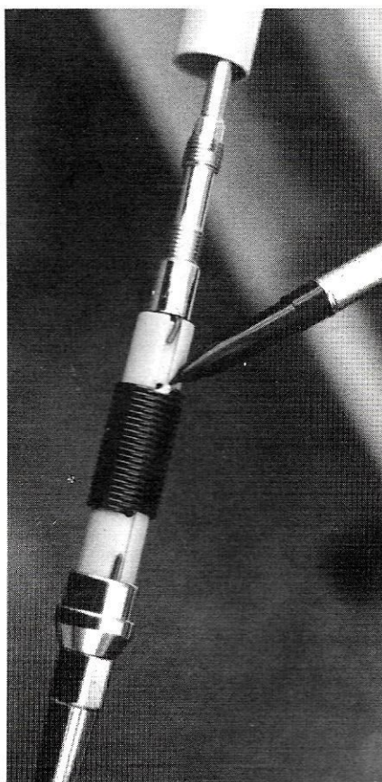
Photo 2 : Emplacement de la soudure sur la self.
