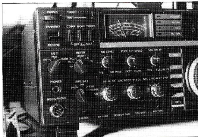
Les commandes à gauche de l'appareil. Notez la commande de la boîte d'accord automatique d'antenne, celle du préamplificateur et celle de l'atténuateur 10, 20 30 dB.
