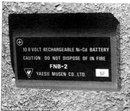
Photo 3 : Groupement d'éléments en boîtier spécial destiné à l'alimentation d'un transceiver portatif (Yaesu FT-208R).
