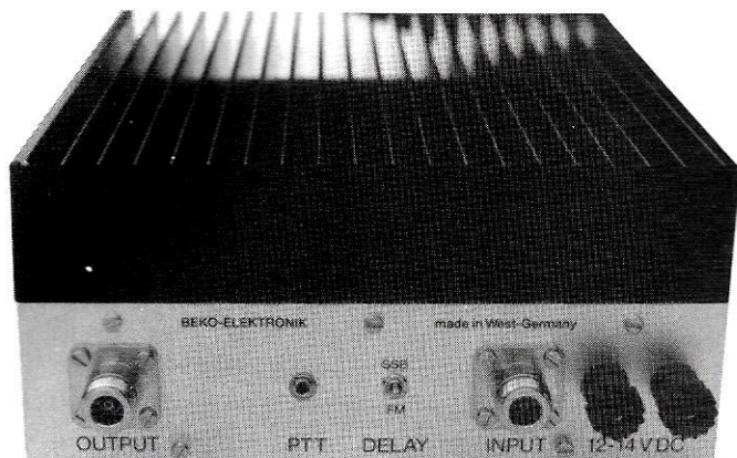
La face arrière de l'ampli. Remarquez l'inverseur SSB/FM.
