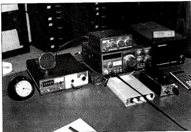
A gauche, le transceiver 10 MHz - 2 W, est un compagnon agréable pour la station 100 W, TS120S. En fonctionnement, il ne fait pas figure de parent pauvre.
