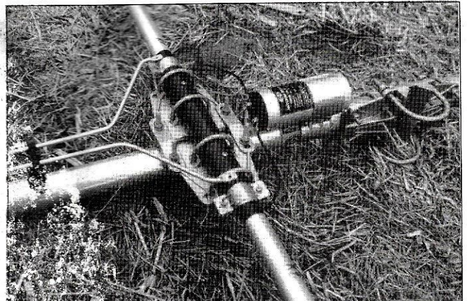
Le balun et les connexions du radiateur
