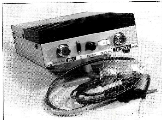
La face arrière et les câbles alimentation et antenne. Remarquez le fusible de rechange...
