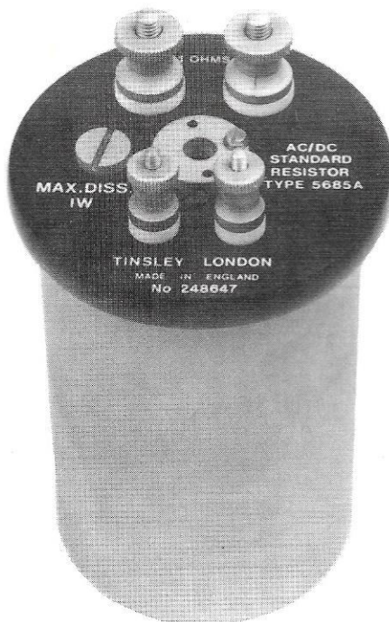
Une résistance étalon de 1 Ω
