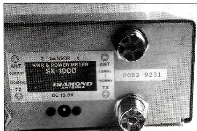
... et sa face arrière où l'on peut voir des prises SO239 type "étoile", remarquez aussi la prise d'alimentation 13,8 V.
