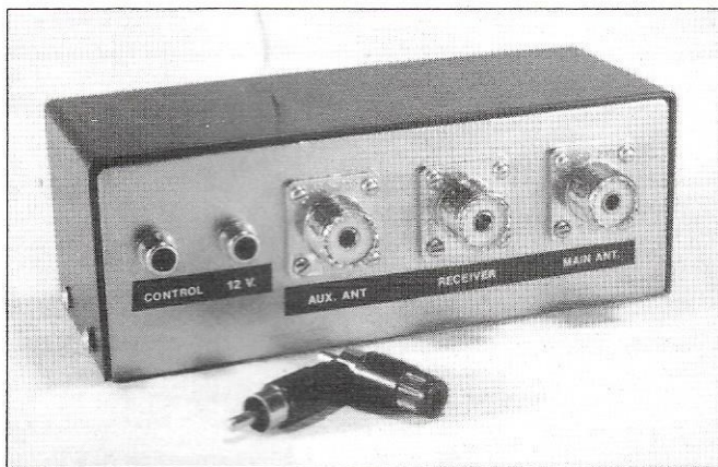
A l'arrière, les prises "antennes".
