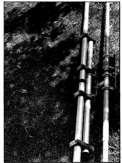
A droite, le montage classique du point central du radiateur d'un dipôle rotatif et à gauche, le montage utilisant des colliers Stauff.
