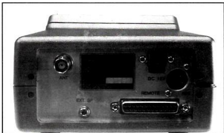
A l'arrière, un connecteur RS-232.
