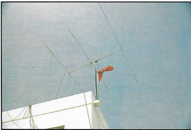
L'antenne 3 bandes 3 éléments utilisée.
