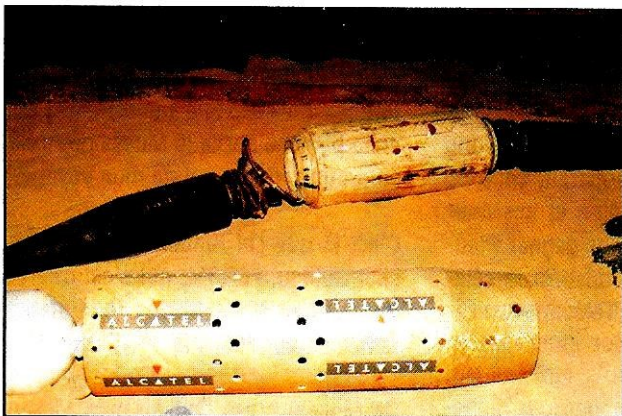
Un câble sous-marin et son répéteur.
