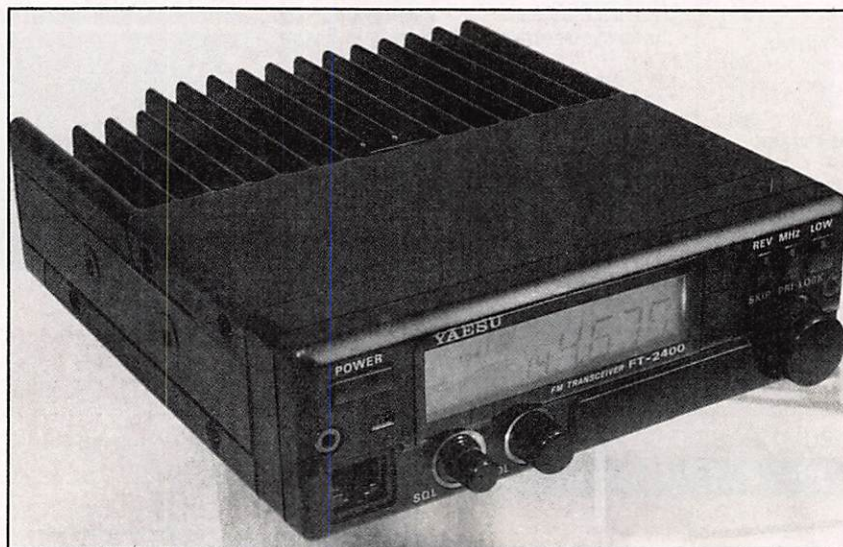
Transceiver d'aspect élégant le FT-2400H est doté d'une prise micro spéciale.
