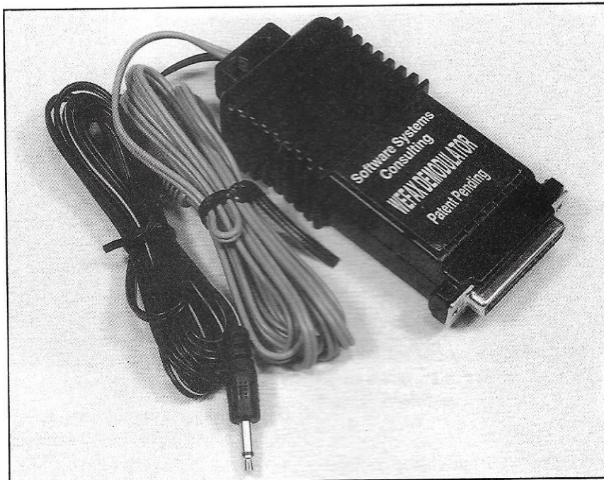
L'interface se connecte directement sur la RS-232.
