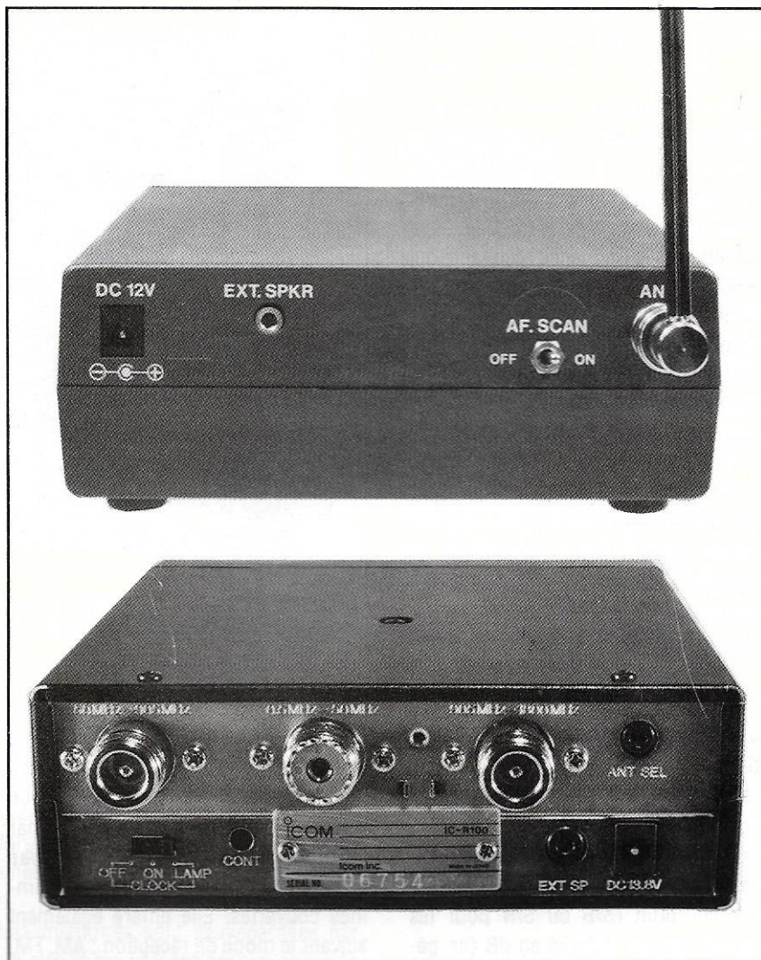
Les sorties d'antennes peuvent être uniques (comme sur la photo du haut) ou multiples, chacune étant affectée à des segments du spectre couvert (photo du bas).
