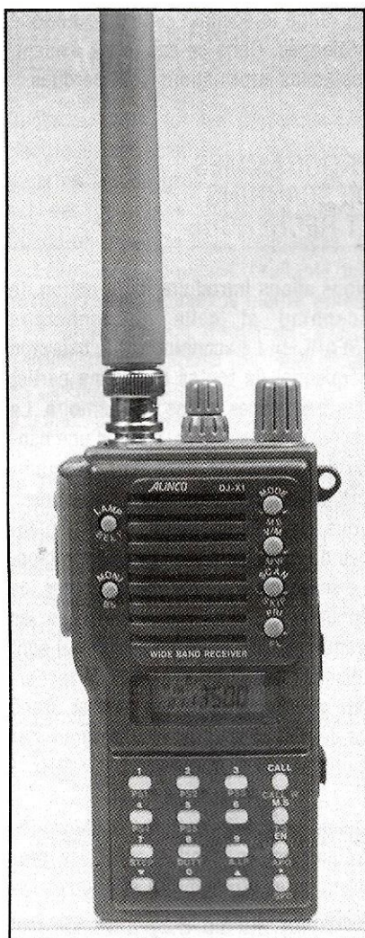
Séduisant pour qui se déplace beaucoup, le minuscule Alinco DJ-X1 tient dans la poche, couvre de 100 kHz à 1300 MHz, mais il faut être prudent avant de le connecter sur une antenne extérieure.
