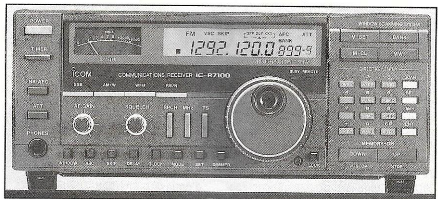
Matériel de table couvrant de 25 à 1300 MHz, l'Icom IC-R7100 est un excellent récepteur tous modes.
