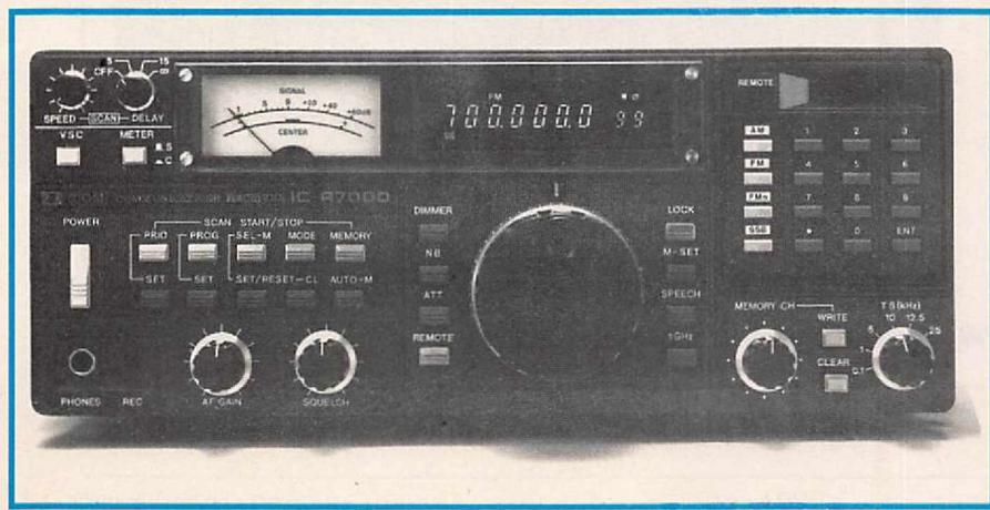
La fonction de balayage vocal, temporisation et vitesse de balayage est programmable sur les deux récepteurs.
